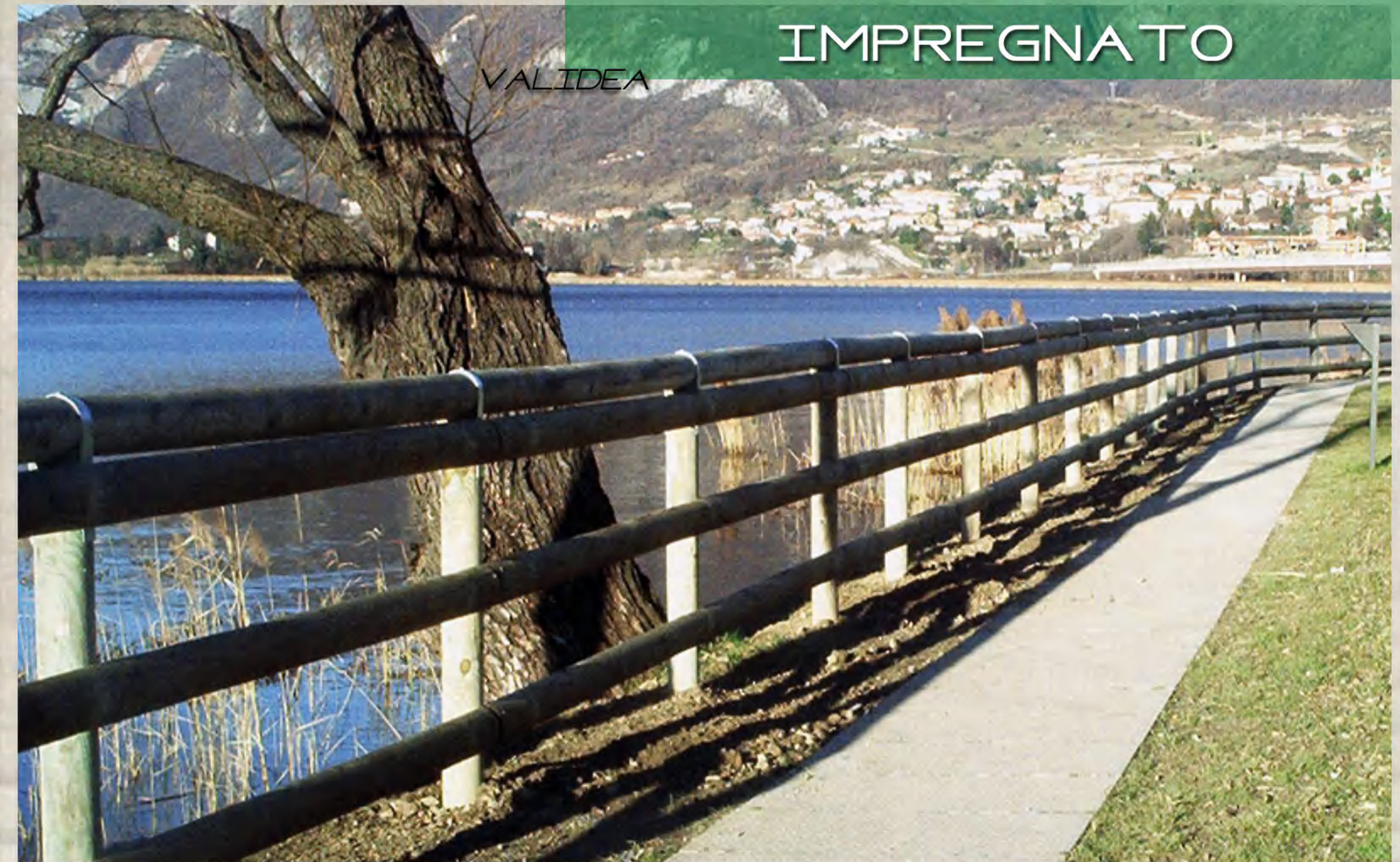
Esempi di staccionate con pali in pino impregnato a pressione in autoclave con sali atossici color verde naturale.
